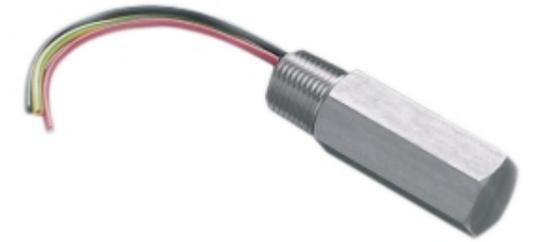
HL系列浪涌保护器用于自动化控制领域现场仪表的浪涌防护。提供传感器、变送器、流量计、电磁阀、阀门定位器、热电阻、热电偶、检测分析等各类仪表的信号防护，其316不锈钢外壳和IP65的防护等级可以适应各种恶劣现场工况。广泛应用于石油化工、天然气、环保、新能源等行业。
