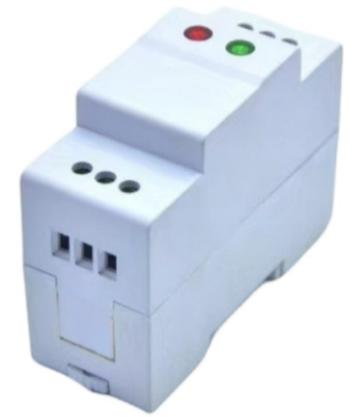
DP20S系列浪涌保护器是根据GB18802.1设计的III级DIN导轨安装的浪涌保护器，广泛应用于电气设备、系统控制柜中的电源进线的III级防护。与I级和II级浪涌保护器共同构成完的分级泄放的防雷系统。
