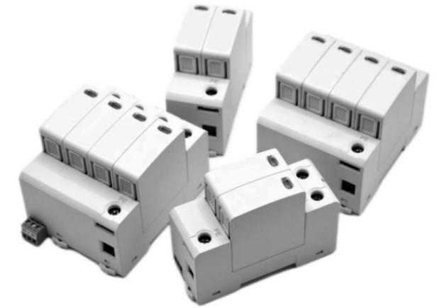
DP40系列浪涌保护器是根据GB18802.1设计的II级DIN导轨安装的浪涌保护器，广泛应用于配电箱、配电柜中的电源进线的II级防护。与I级和III级浪涌保护器共同构成完整的分级泄放的防雷系统。
